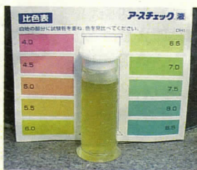
▲農園の土のpH値を計ると、pH5.5～6の値に。皆さんの手入れのお蔭で、理想値のpH6に近い土壌が保たれています。
