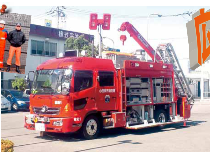
最新鋭のウインチ、クレーン、発電装置を備える救助工作車
