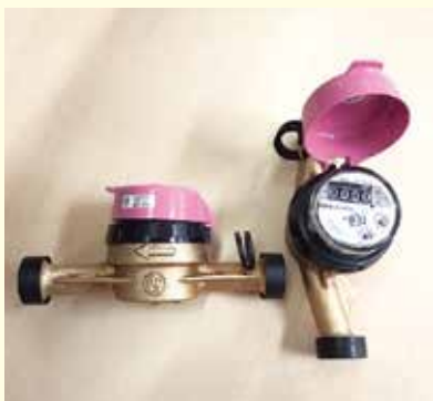
水道メーター器
