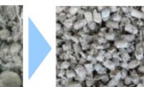
原料の再加工 (粒形の安定化)
