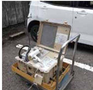
軽自動車から外給電機を用いて 電気を使う様子
